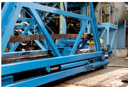
Vysokotlaké výměníky na PS40 HOSD vyžadují každoroční čištění. Manipulaci s nimi obstarává vyřadivák svazků (na snímku uprostřed).
