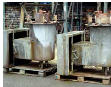
Pec 02H21vakuové destilace má dnes opraveny hořáky. Ty byly v průběhu zarážky z pece demontovány a taktó připraveny k celkové opravě.
